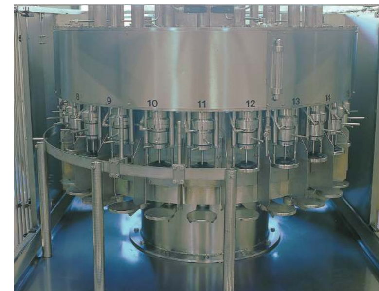
Lado superior y lado frontal del deposito anular de llenado al centro el pulmón de sostén.
